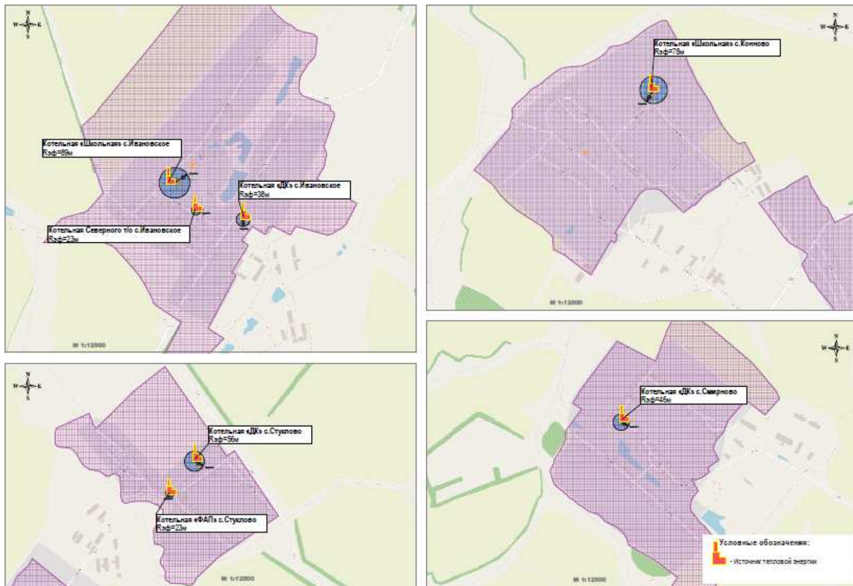
Рис. 2.16. Схема существующих радиусов эффективного теплоснабжения от котельной «Школьная» с. Ивановское, котельной Северного территориального отдела в с. Ивановское, котельной «ДК» с. Ивановское, котельной «ДК» с. Смирново, котельной «Школьная» с. Конново, котельной «ФАП» с. Стуклово и котельной «ДК» с. Стуклово.
